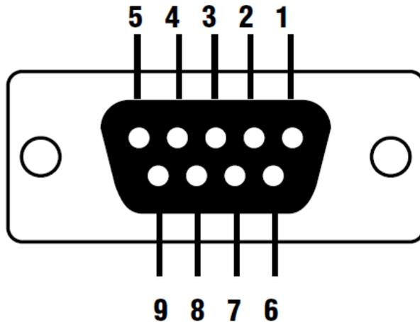
图 2.1 DB9（九针）母头（插孔式接头）
