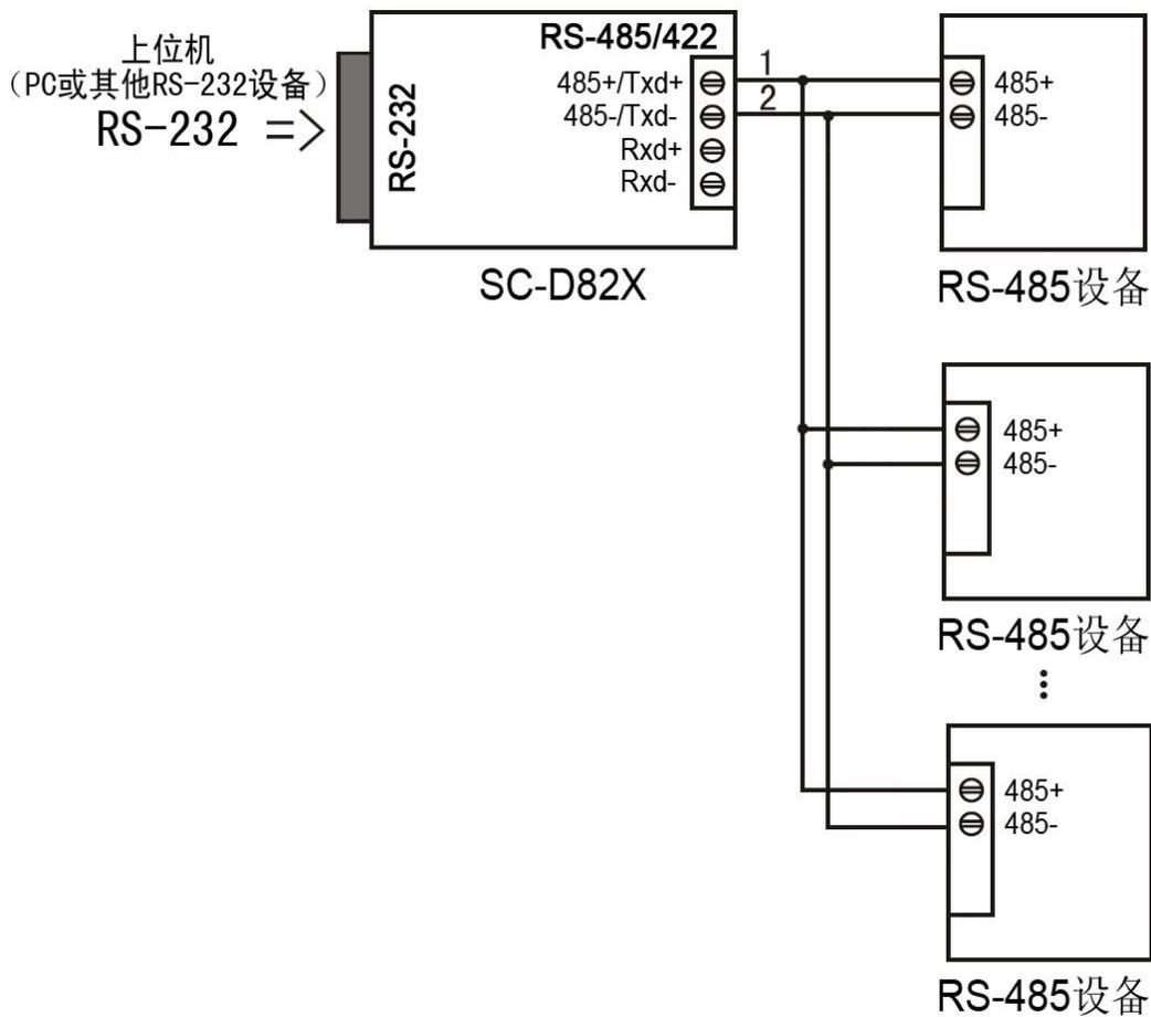
2.2.3.6 SC-D82X 串口转换器之间 RS-485 半双工通信
