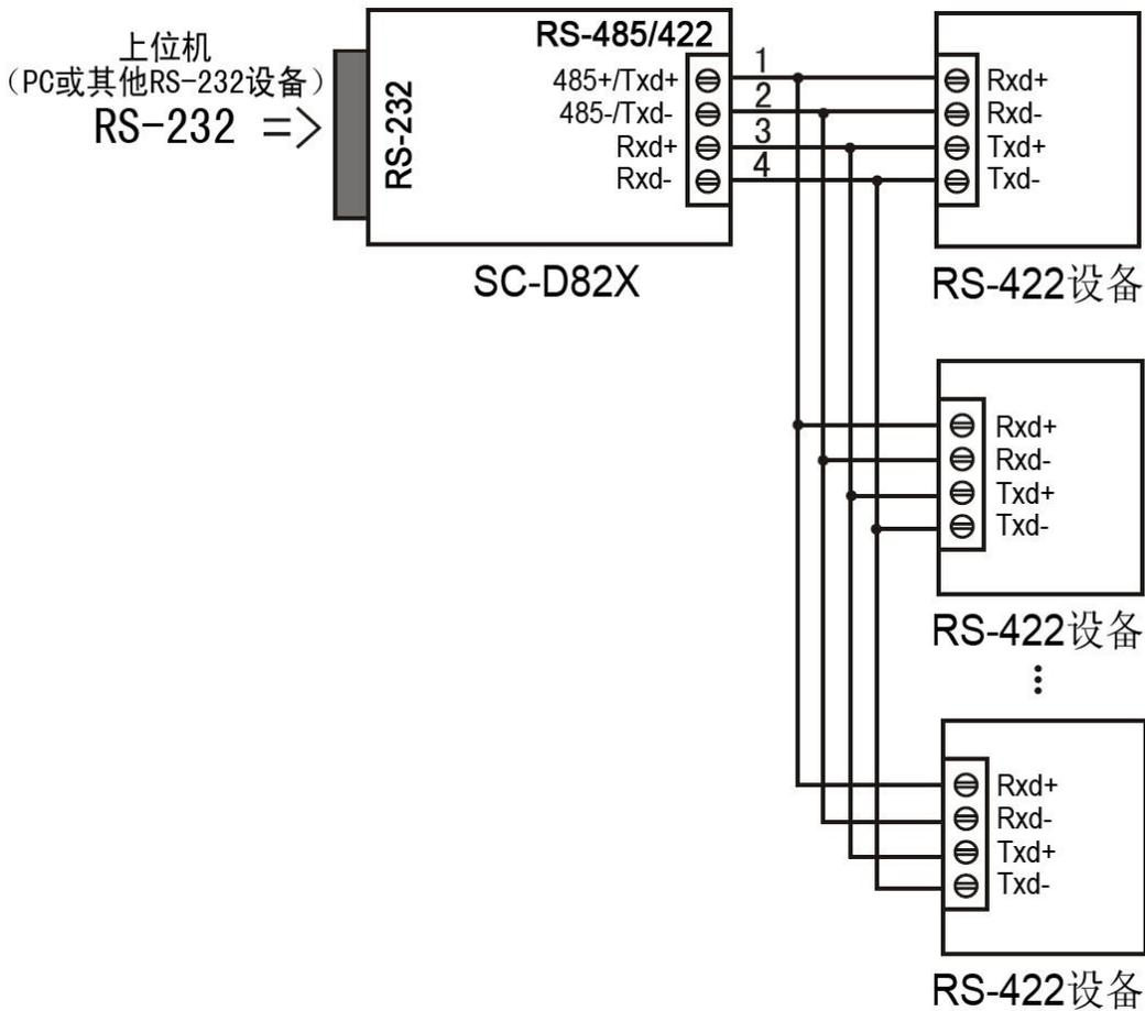
2.2.3.3 SC-D82X 串口转换器之间 RS-422 全双工通信
