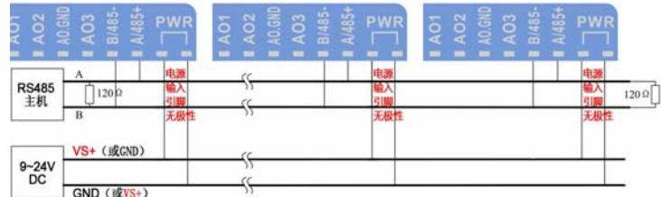
2、请使用 12-24V DC 电源供电, 推荐 24V DC;
