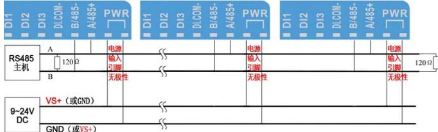
电源输入接口 PWR 的 2 个端子不分极性、可分别连接电源正、负极;
