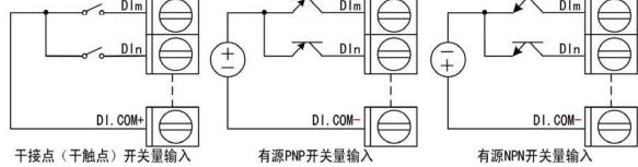
EMR-ED1616 / EMR-ED1616-G 具有 16 路开关量信号输入接口,针对各类型开关量信号,接线方式有所差异,具体接线示意图如下:特别说明:
